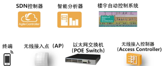
图1-4 WLAN 由多个组件构成
